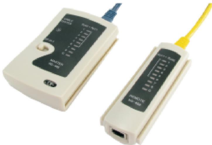
Testador de continuidade/seqüência de cabos montados com RJ11, RJ12 e RJ45. Testa a correspondência de cabos par-trançado, e pode detectar conexões erradas, curto circuitos e circuitos abertos.
