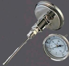
El termómetro ajustable adopta una lámina de metal multicapa como elemento sensor de temperatura para controlar el puntero. La lámina de metal multicapa está formada por dos (o más) láminas de metal que están laminadas juntas.
