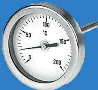
El termómetro bimetálico industrial adopta una lámina de metal multicapa como elemento sensor de temperatura para controlar el puntero. La lámina de metal multicapa está formada por dos (o más) láminas de metal que están laminadas juntas. El elemento funciona según el principio de que dos metales diferentes se expanden en cantidades diferentes cuando la temperatura cambia.
