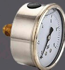
La caja del medidor con relleno de líquido de caja de acero está hecha de hierro de electroforesis, y su estructura interna está hecha de cobre. Es ampliamente utilizado para compresores hidráulicos, sistemas de aire comprimido y sistemas neumáticos y medios fluidos que no obstruyen el puerto de conexión o el latón. Pero no se puede usar en condiciones corrosivas.
