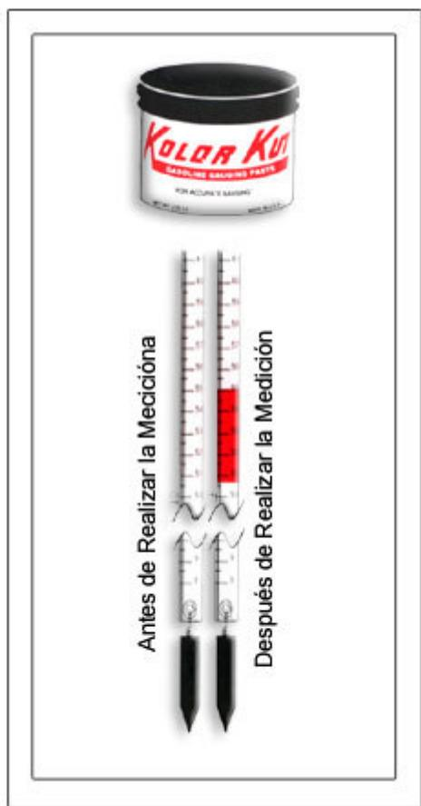
La Pasta Calibradora de Combustibles Kolor Kut, en contacto con productos como Gasolina, Diesel, Nafta, Kerosén, Gasoil, Petróleo crudo, Combustibles de jet, y otros hidrocarburos, cambia inmediatamente de color, pasando de un color rosa a rojo intenso, dejando una marca de contraste claramente visible.
